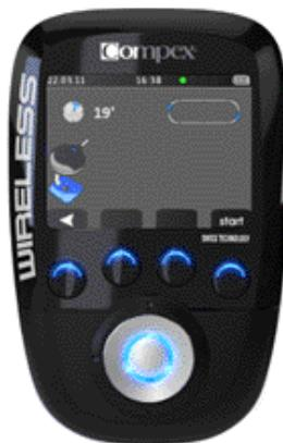
De afstandsbediening toont het symbool van een elektrode en een module die zijn ontkoppeld van het betreffende kanaal (in dit geval kanaal 1).
