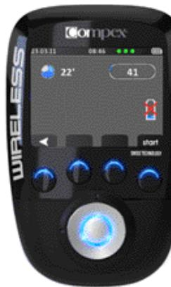
Während der Stimulation kann ein Modul entladen werden. In diesem Fall wird das Symbol einer entladenen Batterie auf dem Kanal angezeigt, auf dem das Problem erkannt wurde (hier Kanal 4).
