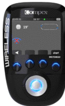
Stimulatorn visar en symbol för signal utanför räckvidden för den kanal där problemet har detekterats (i detta fall kanal 1).
