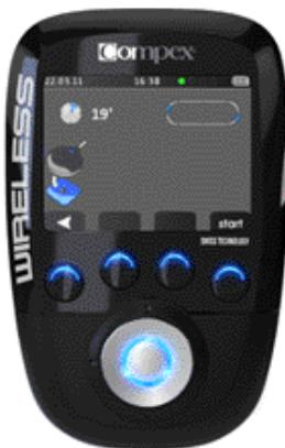
La télécommande montre le symbole d'une électrode et d'un module déconnecté sur le canal en question (dans ce cas, le canal 1).
