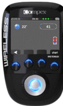
Durante la stimolazione, un modulo può scaricarsi. In questo caso, il simbolo di una batteria scarica compare sul canale sul quale è stato rilevato il problema (in questo caso, il canale 4).
