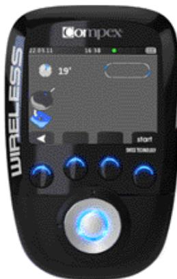
El electroestimulador muestra el símbolo de un electrodo y de un módulo desconectado en el canal en cuestión (en este caso, el canal 1).
