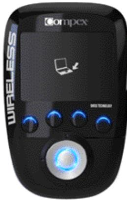
Se o processo de sincronização tiver sido interrompido ou se não poder ser correctamente executado por algum motivo (telecomando desligado, avaria de corrente, etc.), o telecomando pode, em determinados casos, mas não em todos, mostrar este ecrã.
