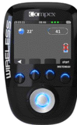
Durant la stimulation un module peut se retrouver déchargé. Dans ce cas le symbole d'une batterie déchargée apparaît sur le canal où le problème a été détecté (dans ce cas, le canal 4).
