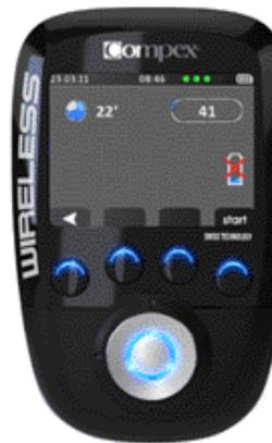
Under stimuleringen kan det hända att en elektrodanslutning blir urladdad. I så fall visas symbolen för ett urladdat batteri för den kanal där problemet har detekterats (i detta fall kanal 4).
