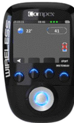
Tijdens de stimulatie kan een module leeg raken. In dit geval zal het symbool van een lege batterij op het kanaal verschijnen waar het probleem is waargenomen (in dit geval kanaal 4).
