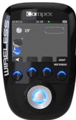
Stimulatorn visar en symbol föreställande en elektrod och en pod som kopplats från för den aktuella kanalen (i detta fall kanal 1).
